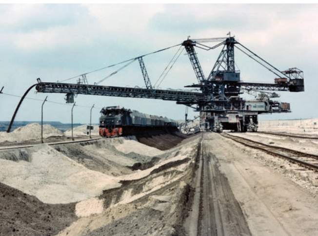
Absetzer 1022-A2s 2240 bei der Abraumverkipfung im Tagebau Golpa-Nord, 1984. © LMBV mbH (René Bär)
