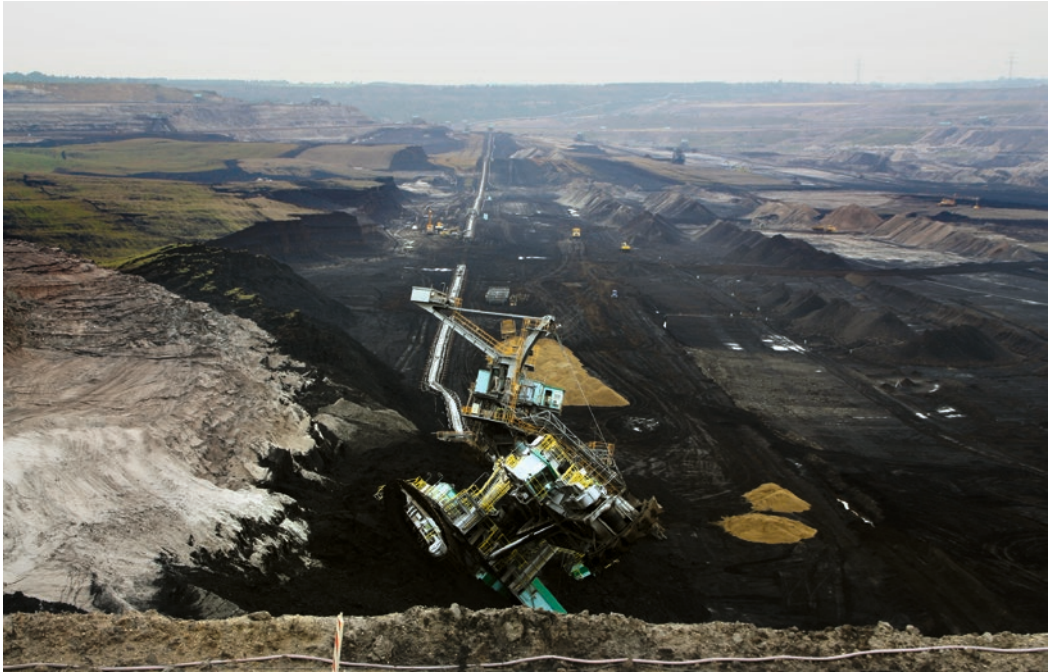
Rutschung Tagebau Vereinigtes Schleenhain, 2012, © Andreas Berkner
