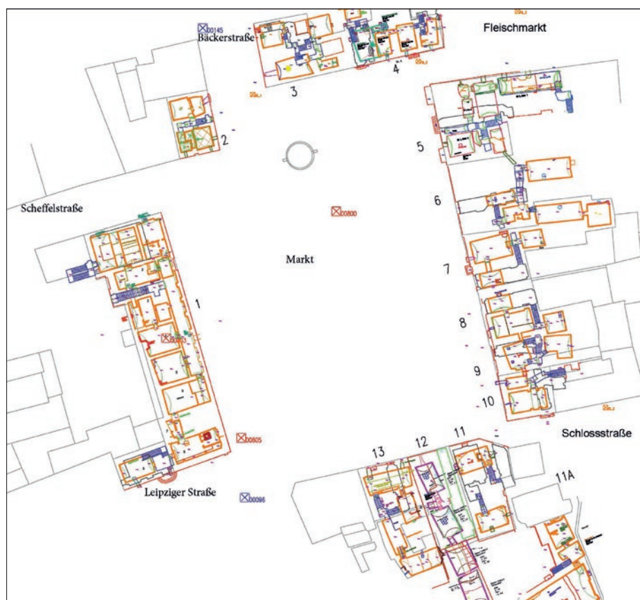
Abb. 40: Kellerstruktur im Markt- und Rathausbereich
