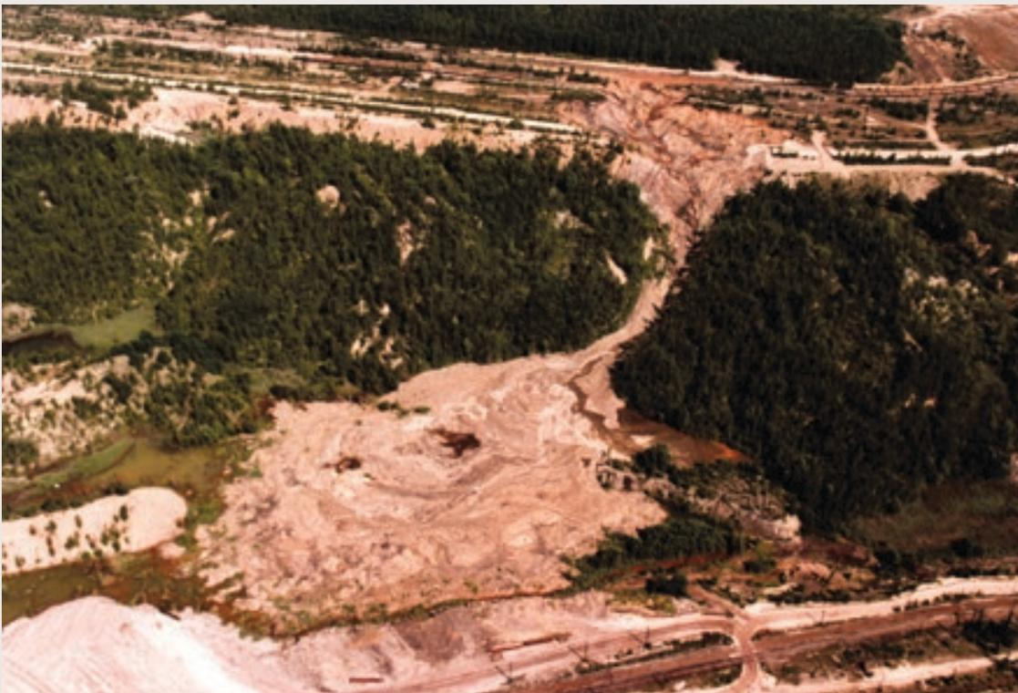
► Luftaufnahme der durch Setzungsfließen ausgelösten Rutschung vom 1.4.1994 im Kippenbereich am nördlichen Stellwerk 101 des Tagebaus Zwenkau. Die über mehrere 100 Meter Breite etwa 150 000 Kubikmeter ausgebrochenen Abraummassen bahnten sich ihren Weg durch die z. T. schon vegetationsbestandene Abraumförderkippe. 1994. Tagebau Zwenkau.
